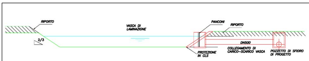
Figura 9 – sezione di un tipologico di bacino di laminazione in linea
